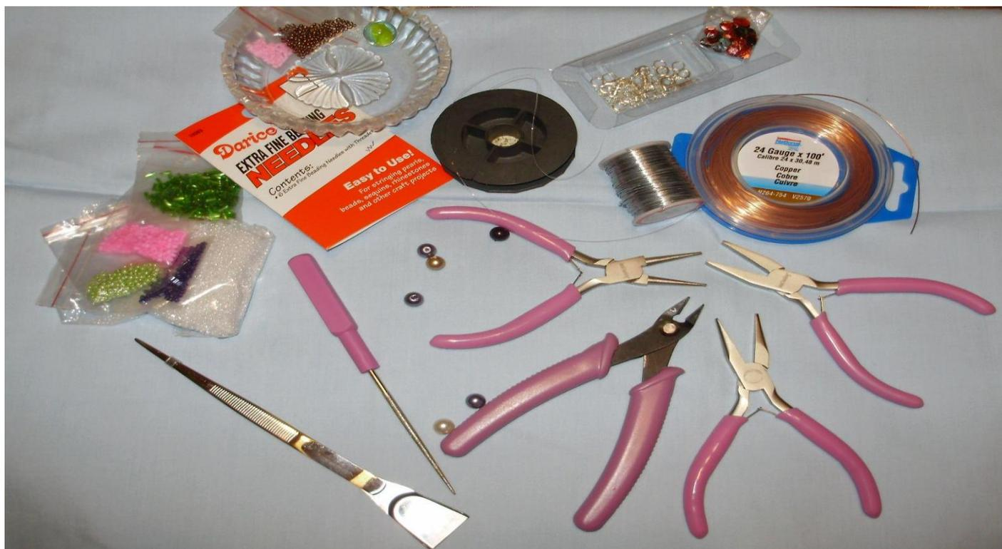
**Проволока.** Медная, латунная, стальная или алюминиевая. Проволоки покрыты лаками разных цветов, имеют оплетку или луженые металлами другого цвета. Проволока выбирается в два-три раза меньшей толщины, чем диаметр отверстия в бисере (бусинах). Проволока по степени мягкости (жесткости) делится на мягкую проволоку для бисероплетения и проволоку для бисероплетения жестких конструкций.
